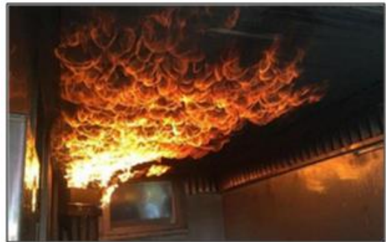
Figura 4: Fase anterior ao flashover - grande desenvolvimento de fumaça e gases, acumulando-se no nível do teto.
