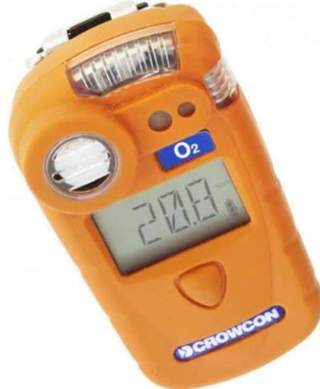
Fonte: Detector Gasman, Crowcon, General Instruments, disponível em <http://www.generalinstruments.com.br>.
