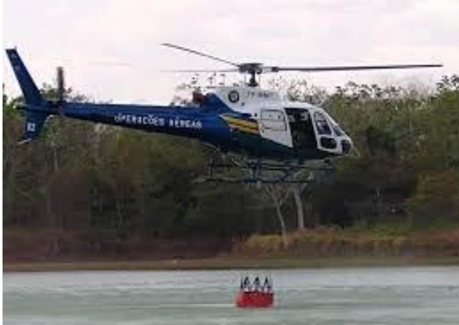
Figura 36 - Helicóptero do CIOpAer, modelo HS350b2 Esquilo, abastecendo o helibalde
